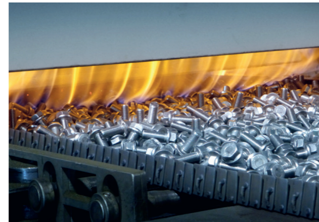
Durch das b&m-EccoTec-Verfahren kann eine Wärmebehandlung während des Produktionsprozesses entfallen. © Barth Galvanik
