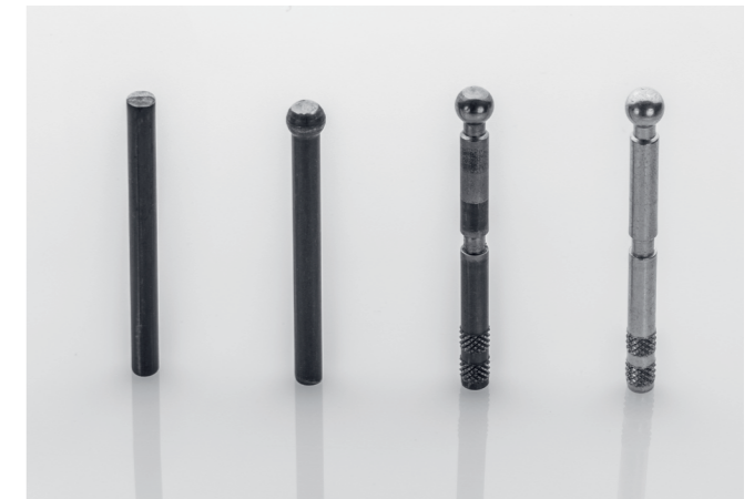
Facettenreiche Geometrien ohne spanabhebende Verfahren: Kugelbolzen, Stadiensatz. © b&m/Rüdiger Dunker
