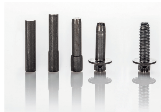
Die Umformtechnik ist ein spanloses volumenkonstantes Fertigungsverfahren. © b&m/Rüdiger Dunker
