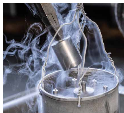
Bild 5: Vor dem Einsatz muss man einen Schrumpfstopfen mit flüssigem Stickstoff auf -196 °C abkühlen, den Formeinsatz als Gegenstück hingegen auf 350 °C erhitzen.
